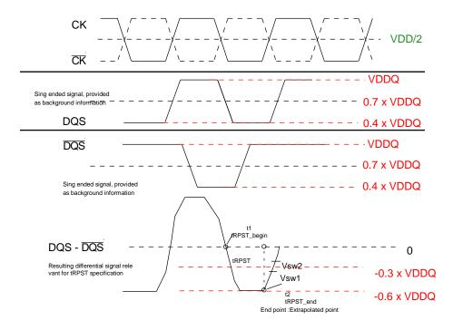
NOTE 1 Low Level of DQS and  $\overline{DQS}$  = VDDQ/ (50+34) x 34 = VDDQ x 0.40
