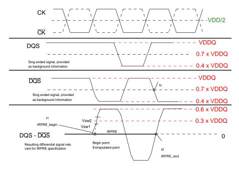
NOTE 1 Low Level of DQS and  $\overline{DQS}$  = VDDQ/ (50+34) x 34 = VDDQ x 0.40
