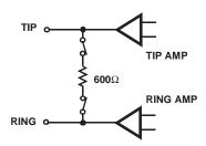
FIGURE 9. FORWARD LOOP BACK INTERNAL TERMINATION
