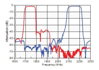
Figure 30: Band 66 Tx-Rx Isolation
