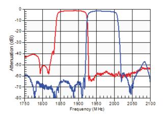
Figure 6: Band 25 Tx-Rx Isolation
