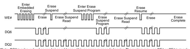
**Note:** DQ2 toggles only when read at an address within an erase-suspended sector. The system may use OE# or CE# to toggle DQ2 and DQ6.
