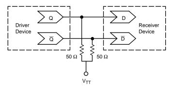
$V_{TT} = V_{CC} - 2.0 V$
