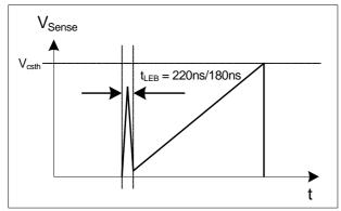
Figure 19 Leading Edge Blanking
